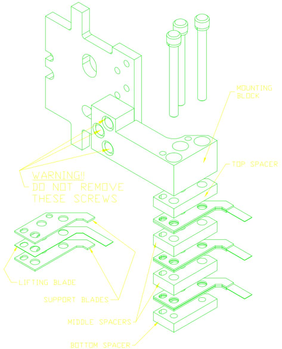
**Figure 17. Blade Stack Components**
